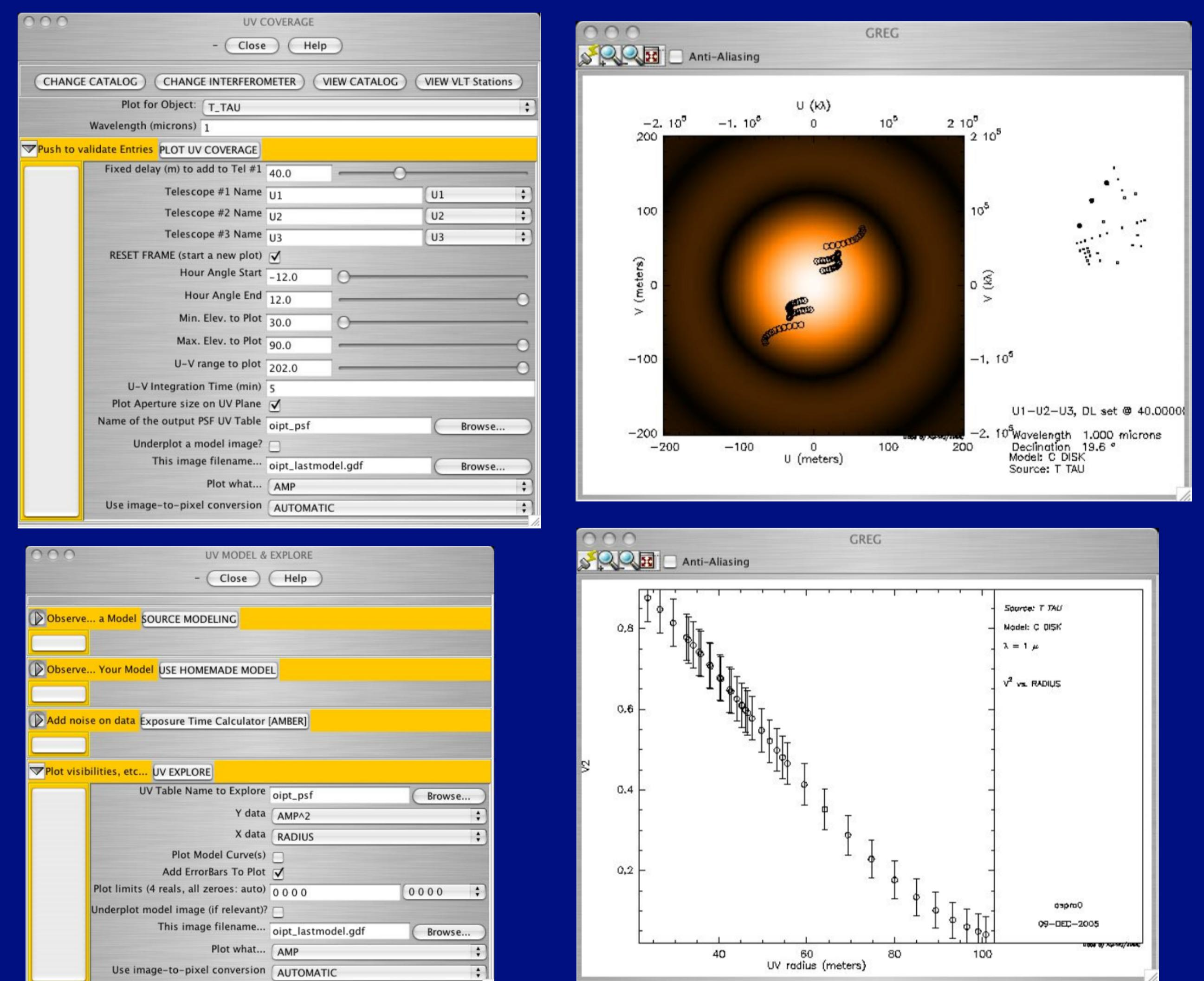
Le groupe maintient un logiciel de préparation aux observations interférométriques pouvant être utilisé pour estimer la faisabilité d'un projet observationnel sur différents interféromètres, en particulier celui de l'Observatoire Européen Austral (ESO/VLTI). Ce logiciel est en partie basé sur la suite logicielle « Gildas » développée conjointement par le LAOG et l'IRAM depuis 1982. Il est utilisé comme support de cours et TP dans les écoles internationales d'interférométrie optique.
